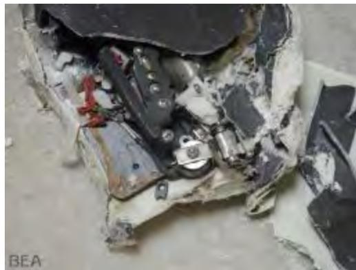
Figure 33 - zoom - mécanisme de bande magnétique après extraction
